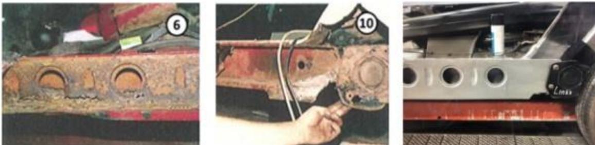
• Die Fahrgestellträger mit Hinterradaufhängung, alt und neu
